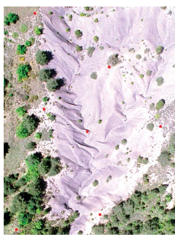
Cartographie 3D du bassin versant Draix (zone de ravins) Il s'agit d'un modèle numérique de surface et non de terrain (courbes de niveau à 30 cm) C. Puech, J.S. Balli, B. Roux (Cemagref), J. Asseline (IRD)
